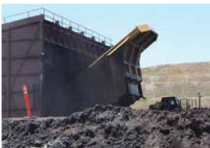
Reducción del polvo con la Tolva con Control de Flujo Westech
